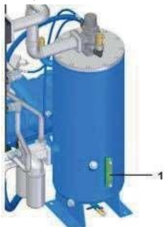
Рис. 31: Проверка уровня компрессорного масла через смотровое стекло
