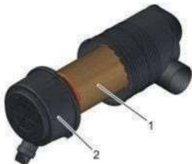
Рис. 42: Разборка корпуса воздушного фильтра
