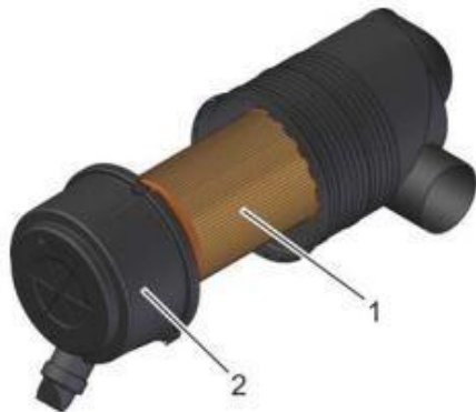
Рис. 38. Разборка корпуса воздушного фильтра
