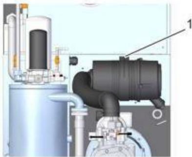
Рис. 37. Расположение воздушного фильтра
