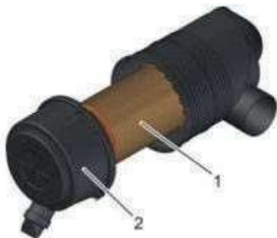
Рис. 42: Разборка корпуса воздушного фильтра
